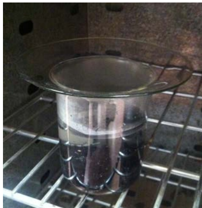
Figura 2 Detalle vaso de precipitados con vidrio de reloj en estufa ventilada
